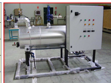
Caldera eléctrica fluido térmico 90kw – 120°C Suministrada para calentar fuel-oil.
